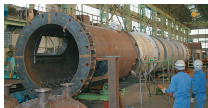
溶媒分離塔&コンデンサー [2,100 φ ×24,500 H ]
