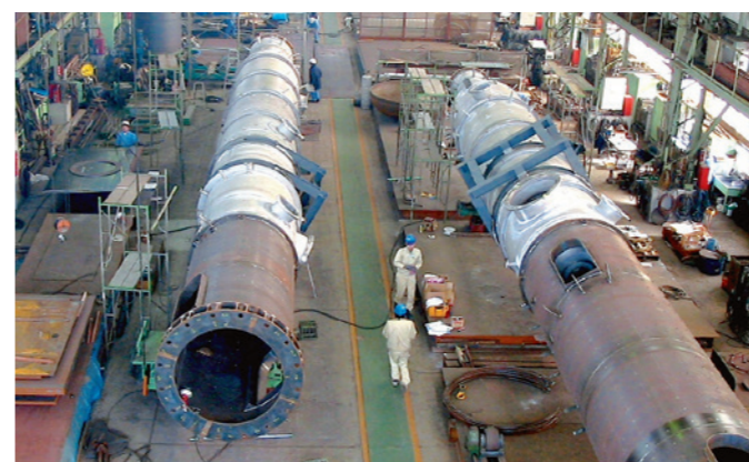
溶媒分離塔及び初留塔
