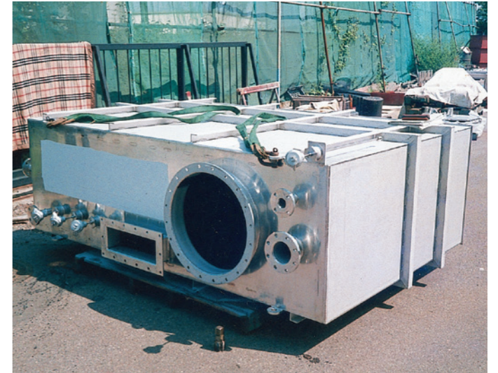
タイ向 洗浄液槽 [3,500 L ×1,500 W ×2,500 H ] (SUS316L)
