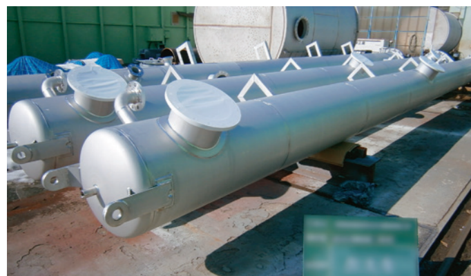
消化ガス精製装置
