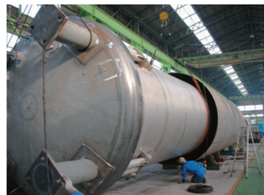
60 kL 真空断熱貯槽
