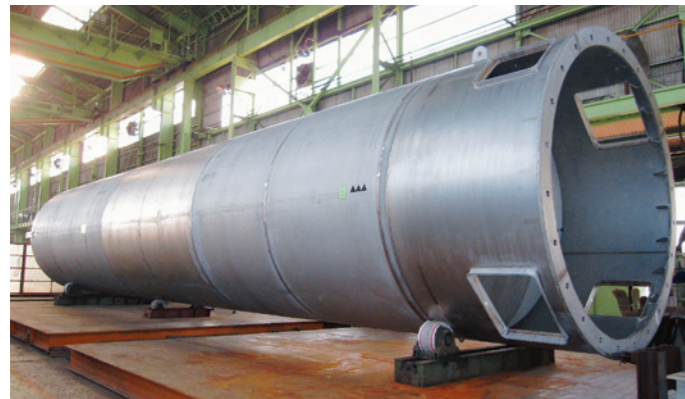
150 kL LNG貯槽 [3,400 φ ×15,400 H +2,000 H ]
