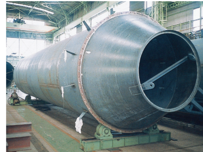
煙道工場製作 [3,200 φ ×15,000 H 3基]
