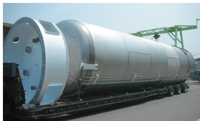
LNG貯槽 [3,400 φ ×12,100 H ]
