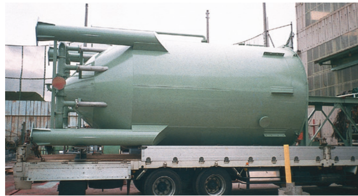
砂ろ過槽 [30m 3 8基]
