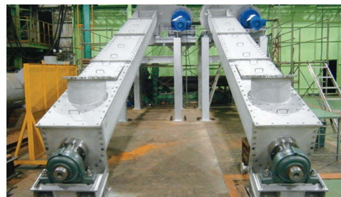
珪砂抽出コンベヤ
