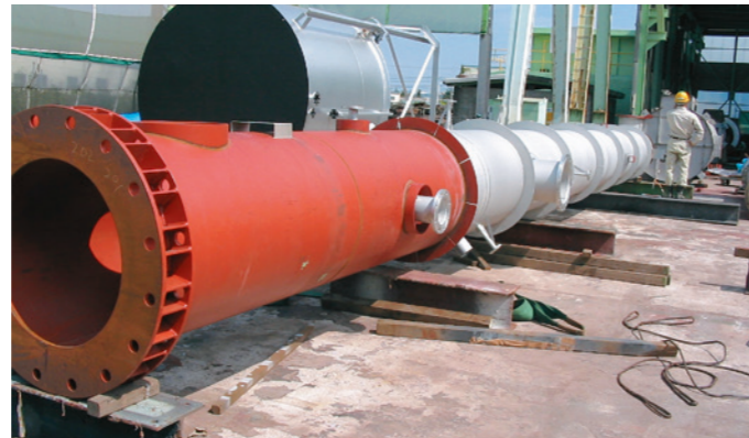
第2蒸留塔 オイル回収塔 下部 [900 φ ×15,373 H ]
