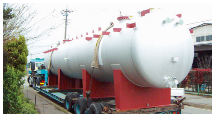
溶剤貯蔵タンク
