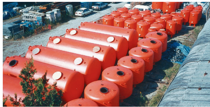
急速ろ過器 [50m 3 他75基]
