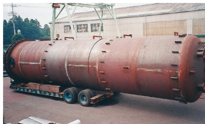
活性炭吸着槽
