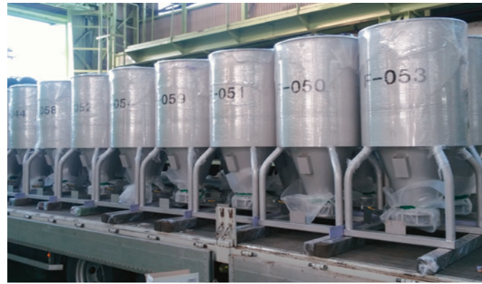
移動コンテナ [778.4 φ ×1,580 H 39基]
