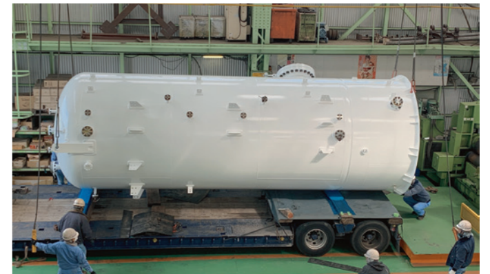
プロピレン移送タンク [2,500 φ ×5,500 H ] (高張力鋼特定設備)
