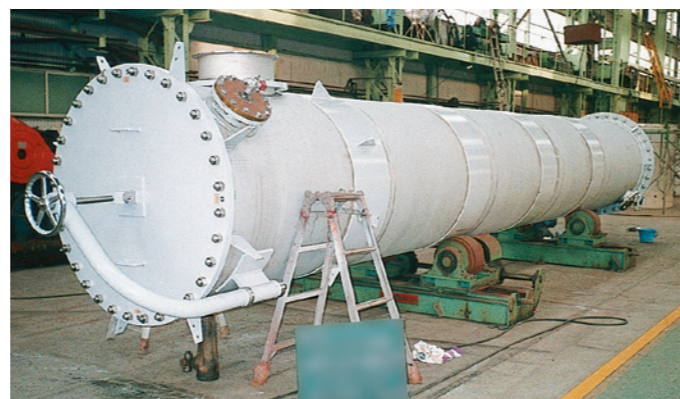
サーフェイスコンデンサー [1,200 φ ×9,500 H ] (SUS316)
