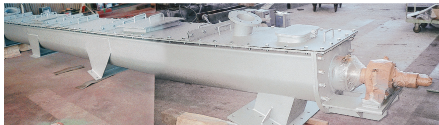
砂冷却スクリーコンベア [270 φ ×7,500 L ]
